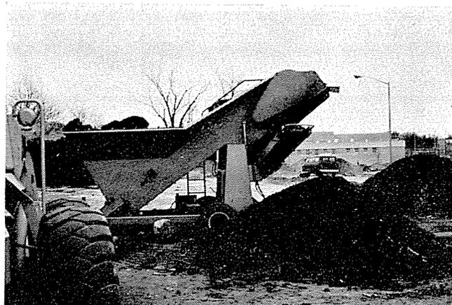
Abb. 4: Der für die Herstellung der Rasentragsschicht verwendete Oberboden wird mit einem Shredder-Mixer gereinigt. Diese Maschine ist befähigt, Steine und andere unerwünschte Verunreinigungen vom Oberboden auszuscheiden sowie Erdschollen zu zerkleinern. Besonders geeignet ist die Maschine für das Mischen von Oberboden mit Zuschlagstoffen. Die Durchsatzleistung beträgt 80 bis 100 m<sup>3</sup> pro Stunde.
