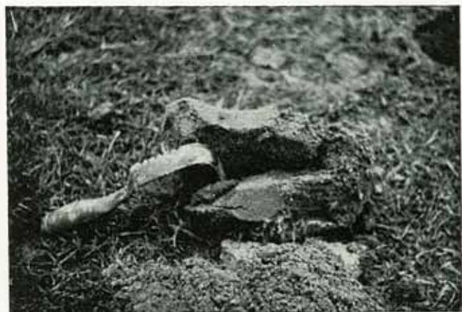
Abb. 1: Plattige Verdichtungen innerhalb der Rasentragschicht
