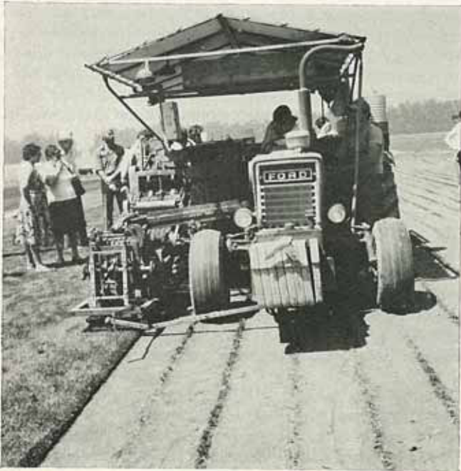
Abb. 1: Einsatz einer vollautomatischen Rasenschälmaschine zur Bewertung von Fertigrasen
