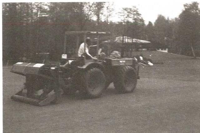
Abb. 4 Tiefenlockerung eines Greens mit Verti-Drän-Gerät
