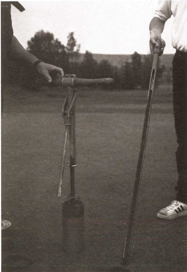
Abb. 4: Lochheber und Bohrstock nach der Probenahme (Aufnahme im Juli 1987)
