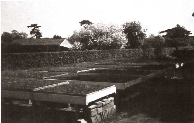
Versuche zur Dachbegrünung der Universität Hannover
