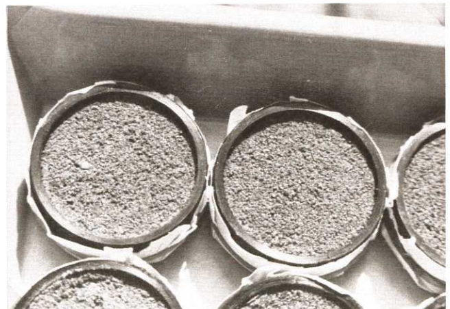
Abbildung 4: Volumenschwund der Gemische durch Entwässerung bis pF 4,2, dargestellt an der Gerüstbaustoffmischung (links) und der Mischung mit Blähton (Mitte); Innendurchmesser der Ringe 5 cm.
