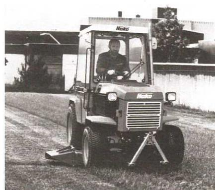
**Abb. 3:** Der neue Hakotrac 4100 Diesel — Kompakttraktor mit 30 kW (41 PS), hydrostatischem Fahrtrieb, vollhydraulischer Lenkung, breitem Anbauprogramm. Hier z.B. mit Zwischenachs-Rotationsmäher. Geringer spezifischer Bodendruck auch bei voller Zuladung durch Niederdruckbereifung mit Rasenprofil.
