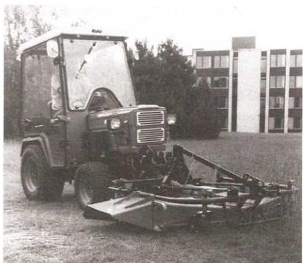
**Abb. 1:** Hakotrac 2700 — Ein neuer Kompaktschlepper, der mit 18 kW (25 PS), wahlweise auch mit Allradantrieb ausgerüstet ist. Für alle Arbeiten rund ums Jahr: Rasen- und Sportplatzpflege, Winterdienst, Freikehren und Bodenbearbeitung.
