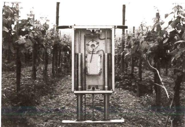
Abb. 3: Penetrograph zur relativen Dichtemessung bis 45 cm Bodentiefe.
