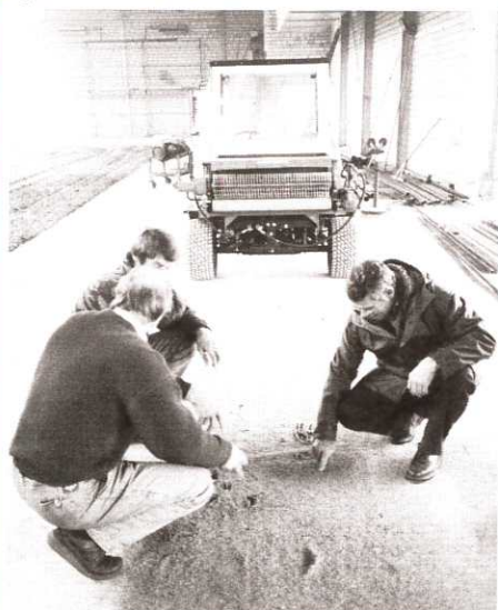
Abb. 4: Exakte Mengendosierung, hier beim Sandstreuer, fördert Arbeitsqualität und spart Mitteleinsatz.
