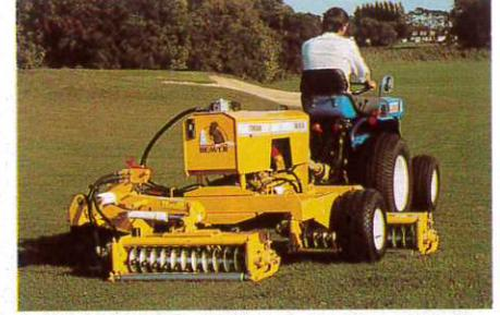
Austauschbare Vertikutiereinheiten, Arbeitsbreiten 210—487 cm
