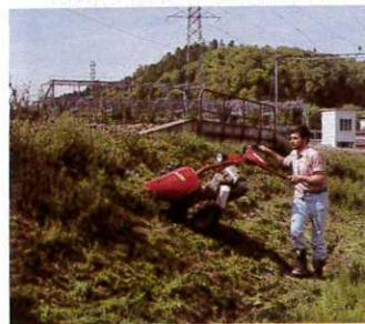
AEBI-Böschungsmäher mit niedrigem Schwerpunkt und großen Rädern, Motoren mit 5, 8 und 11 PS
