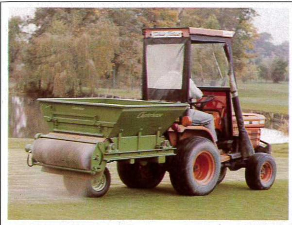
Besandungsgerät für exklusive Rasenflächen, Arbeitsbreite 100 cm, 4-fach-Bereifung auf Wunsch, Antrieb über Hydraulikmotoren
