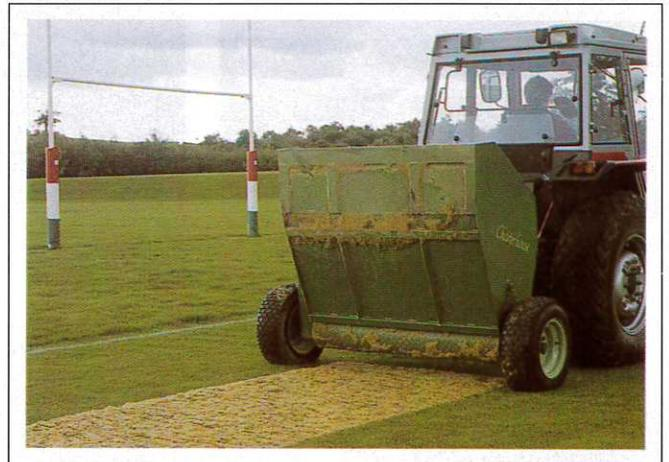
Sportplatzsandstreuer, Arbeitsbreite 140 cm, Einmannbedienung durch Selbstlader, gleichmäßige Ablage des Streumaterials durch Radantrieb
