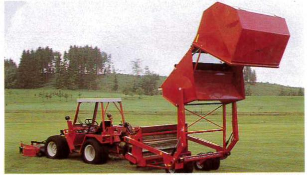
Hydraulische Entleerung des Behälters. Bei Modellen mit Hochentleerung: Kipphöhe 170 cm oder 200 cm. Behälter von 2,5 cbm bis 5 cbm
