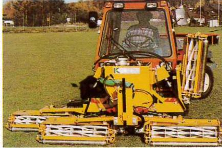
Anbauspindelmäher f. Hubhydraulik, für Front- und Heckanbau, Arbeitsbreite 210 und 340 cm
