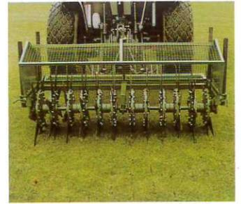
Aerifiziergeräte für die Normdreipunkt, Arbeitsbreiten 105, 165 und 200 cm
