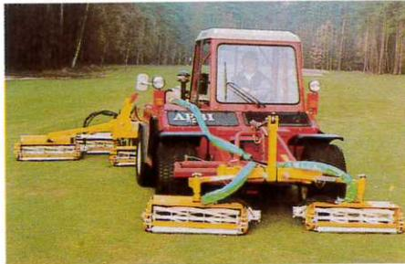
AEBI Terratrak mit Front- und Heckspindeln für spurenfreies Mähen
