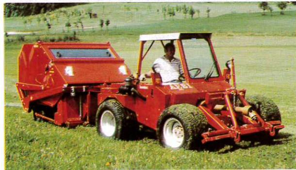
Zum Aufsammeln von Gras und Laub, auch in Verbindung mit Vertikutier- und Schlegelmäherwerkzeugen, Arbeitsbreiten 120, 150, 180 cm
