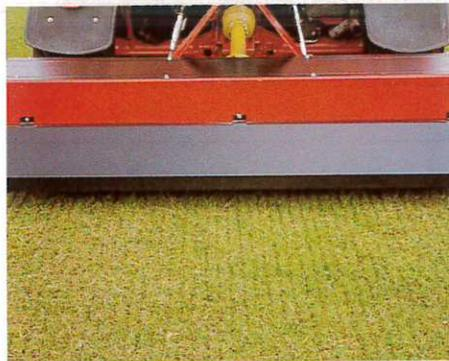
Vertikalschneider für den Anbau an die Schlepperhydraulik
