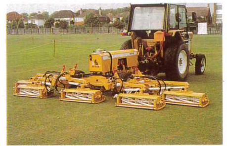
Arbeitsbreiten von 210—487 cm, alle Mäher mit eigener Hydraulik
