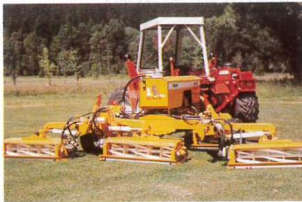
Schneidzylinder mit 4, 6 und 8 Spindelmessern, versch. Zylinderdurchmesser lieferbar
