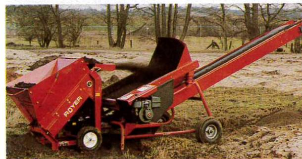
ROYER Erdaufbereiter zerkleinern, sortieren Steine aus, sieben und transportieren Material, Geräte von 12 cbm/h bis 300 cbm/h
