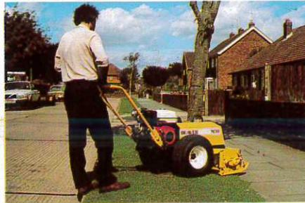
Spindelmäher mit hydrostatischem Fahrtrieb für Kleinflächen und Randstreifen
