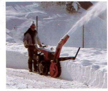
Schneefräsen mit Arbeitsbreiten von 60—100 cm, Motoren mit 8, 11, 18 PS
