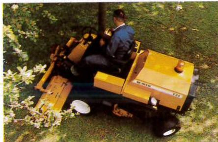
Spindelmäher 213 cm, 28 kW/38 PS Diesel, 4, 6 u. 8 Blatt-Spindel, vollhydr. Allradantrieb
