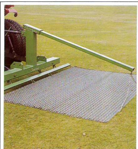
Sportplatzschleppnetz mit hydraulischem Ausheberahmen
