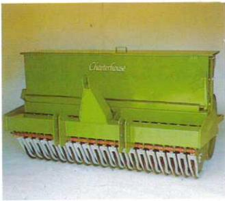
Nachsäegeräte-Overseeder, Arbeitsbreite 160 cm und 200 cm, einzeln aufgehängte Werkzeuge
