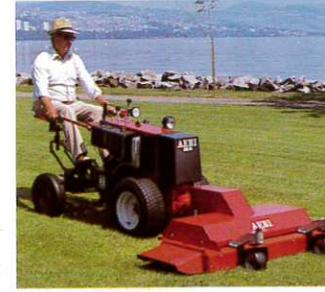
Mehrzweckmaschine AEBI KM 34 (11 PS), KM 54 (18 PS) mit hydrostatischem Antrieb
