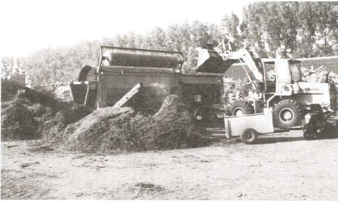
Abb. 3: Geschreddertes Pflanzenmaterial und Golfplatzrasenabfall werden durch die Siebanlage geschickt.
