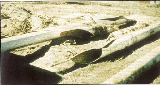
**Zerstörte Robre aufgrund eines Druckstoßes im System**
