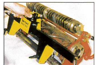
hat an der Schneidkante eine abgerundete Vorderkante bekommen. Hier wird der Rapid Facer einfach mit Hilfe von zwei Magneten an der Unterseite des Schneidwerkes angesetzt, also an der Flachseite des Untermessers. Mittels Feineinstellung wird der gleichmäßige Lauf entlang der
