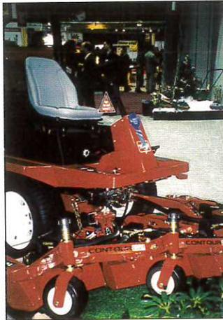
**Bodenanpassung durch einzeln aufgehängte Sichel-Mäheinheiten**
