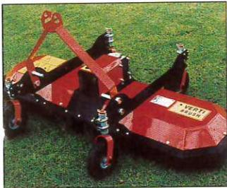
gebrachten Quarzsand. Vier rotierende Tellerbürsten, deren Bürstenelemente schneckenförmig ausgebildet sind, arbeiten den Sand ein. Eine weitere Bürstenleiste richtet die Gräser wieder auf. Durch die spezielle Form der rotierenden Werkzeuge wird der überschüssige Sand nicht als Streifen abgelegt, sondern weitertransportiert und gleichmäßig verteilt. Das VERTI-BRUSH-Gerät arbeitet den Sand besser und schonender ein als Schleppnetze oder ähnliche Systeme.
