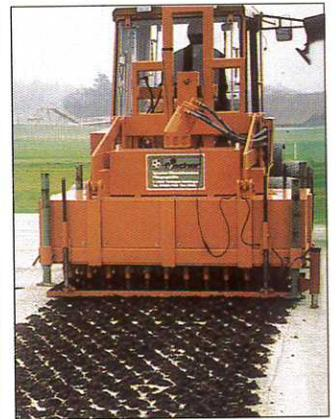
Bodens, sauber geschnittene Lochränder, dadurch leichtes Verfüllen der Löcher mit Sand. Die Arbeitstiefe beträgt bis 40 cm. Fischer-Rasenigel ist ein Gerät, das auf keinem Golfplatz fehlen darf. Ob Vertikutieren, Einebnen von Wurm Kot oder Einarbeiten von Sand, die gründliche und zeitlich schnelle Arbeit überzeugt jeden Greenkeeper.
