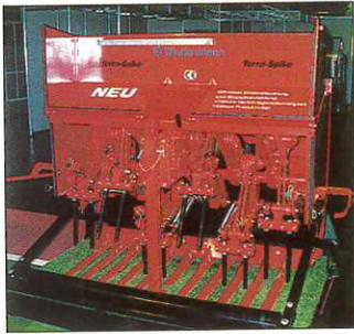
schnelles und fehlerfreies Einstellen der Maschine ermöglicht. Die Maschine wird in den Arbeitsbreiten 1,35 m; 1,6 m; 2,1 m und 2,6 m angeboten.
