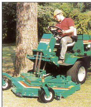
Verringerter Geräuschpegel, bessere Wartungsmöglichkeit und höhere Flächenleistung sind ebenfalls drei grundsätzliche Verbesserungen an der 97er Version von Ransomes bekannten Großflächen-Rotationsmähern. Früher als Rider Rotary T-51 D bekannt, ist das neue Modell Front Line 951 konstruiert als robuste Hochleistungsmaschine. Der 951 hat seitliche, einzeln aushebbare Mähköpfe am Grundgerät wie auch den vorderen Mähkopf mit einer Gesamtarbeitsbreite von 2,95 m.
