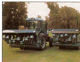
Den Soil Reliever gibt es in den Arbeitsbreiten 1,20/1,50/1,80/2,00 m, die Arbeitstiefe beträgt bis zu 36 cm. Durch die Quick-Step-Federung ist eine Arbeitsgeschwindigkeit von bis zu 2,3 km/h bei vergleichbarem Lochabstand möglich.
