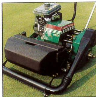
Eine wirksame Alternative zum Abbürsten oder Abfegen der Feuchtigkeit auf feinem Rasen kann mit dem Ransomes Greens Super kombiniert werden. Der Luft-Groomer als Sonderausstattung besteht aus einer über die ganze Schnittbreite reichenden, höhenverstellbaren Düse, die vor dem Grasfangkorb angebracht wird, einer Luftzuführung und einem über Keilriemen angetriebenen Radialgebläse. Das Gebläse liefert mehr als 5,6 m<sup>3</sup> Luft pro Minute.
