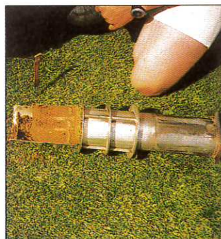
Grüns-Substrataufbau nach dem Umbau; Bearbeitung des Soden-Horizontes durch Aerifizieren
