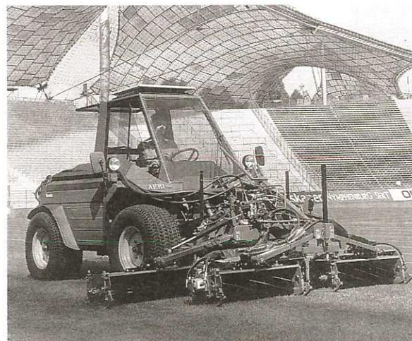
AEBI Terratrac mit vollhydraulischem Spindelmäher
