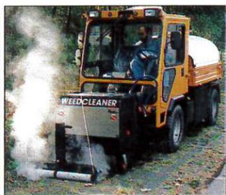
Das Verfahren: Es wird Dampf mit einer Temperatur von 120°C bis 140°C und einem Druck von ca. 60 bar auf die Pflanzen aufgesprüht. Der Dampf dringt unter Druck schnell bis in die in der Bodenoberfläche liegenden Pflanzteile und zu dem Vegetationspunkt vor. Auf der kälteren Pflanzenoberfläche kondensiert der Dampf und wird durch die Kondensationsenthalpie bei 100°C zu Heißwasser. So wirkt die maximale Energieübertragung auf den Vegetationspunkt und zerstört diesen.
