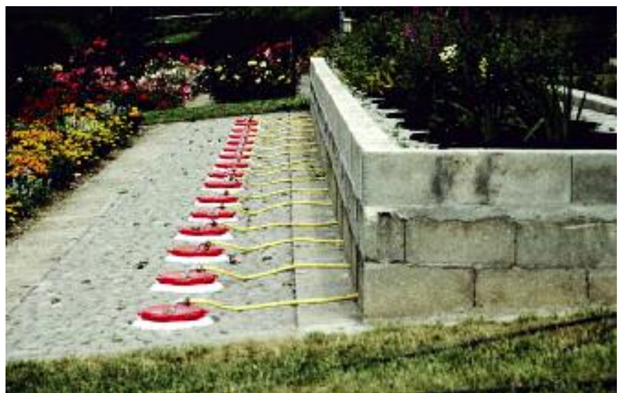
Lysimeteranlage zur Bestimmung der Verdunstungsleistung verschiedener Vegetationsformen bei Intensivbegrünung.
