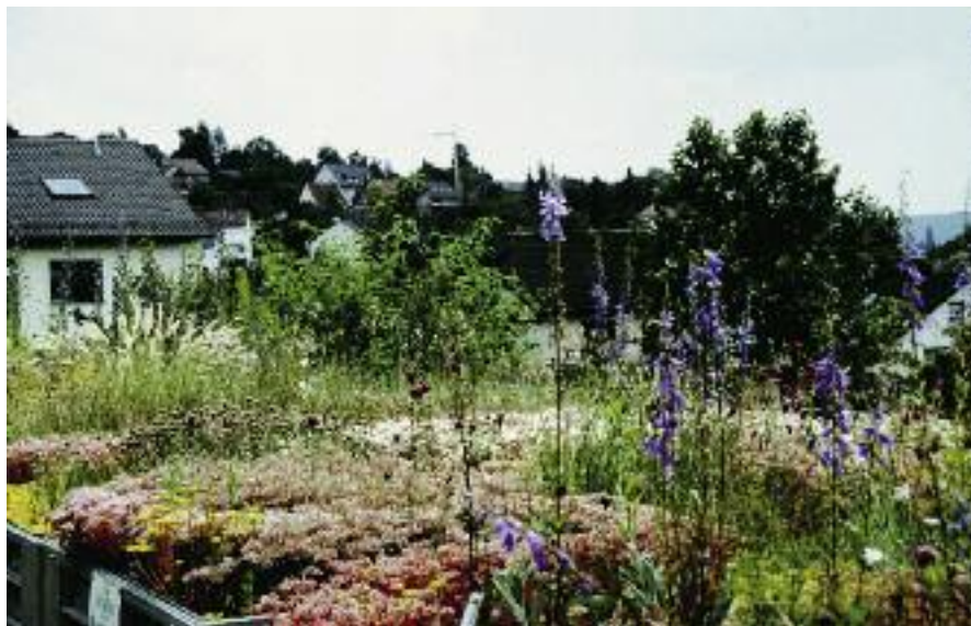
Versuchsdächer zur Messung der Wasserqualität bei älteren Extensivbegrünungen.
