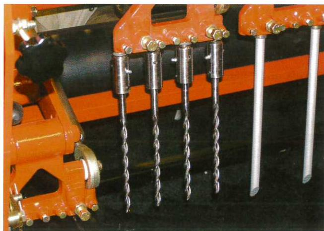
Bohrer am Vertidrain-Gerät
