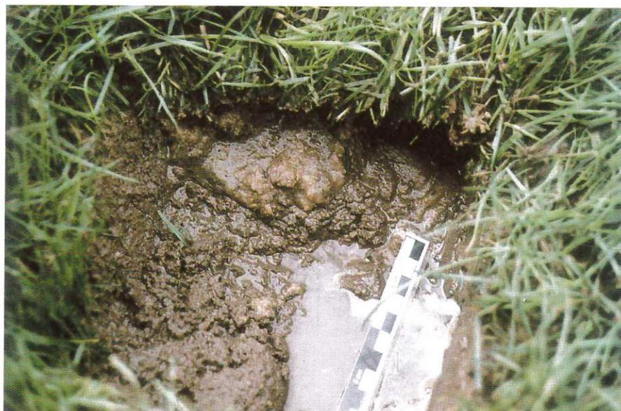
Abb. 2: Zu geringe Wasserdurchlässigkeit der Rasentragschicht durch einen zu hohen Anteil an bindigem Oberboden. (Foto Armbruster)
