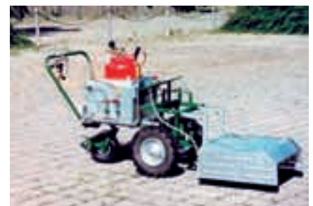
Abb. 1: Links ein Abflammgerät für den Einsatz zwischen den Reihen oder auf den Reihen im Voraufbau (Photo: Schaffner Terra-Tech AG), rechts ein Abflammgerät für den Kommunalbereich (Photo: Fa. Reinert).
