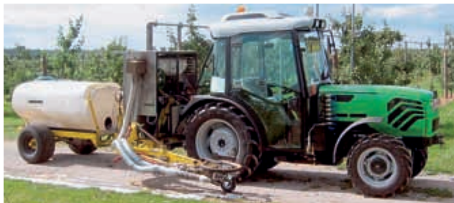
Abb. 4: Das Hohenheimer Heißschaum-Versuchsgerät im Dreipunktanbau eines Deutz Obstbauschleppers mit angehängtem 1000 Liter fassenden Tankwagen.
