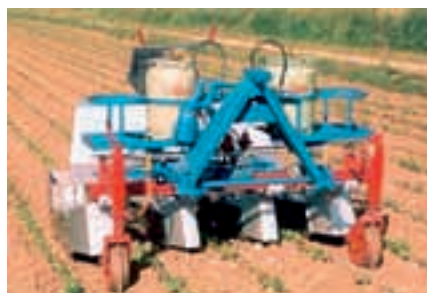
Abb. 1: Links ein Abflammgerät für den Einsatz zwischen den Reihen oder auf den Reihen im Voraufbau (Photo: Schaffner Terra-Tech AG), rechts ein Abflammgerät für den Kommunalbereich (Photo: Fa. Reinert).
