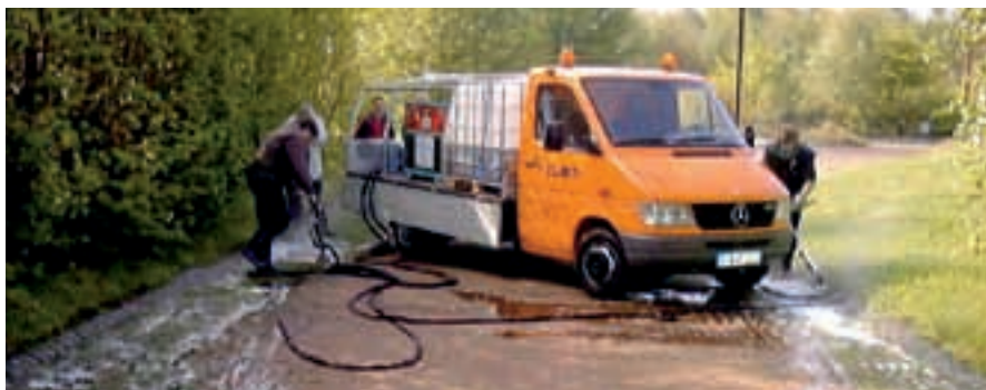
Abb. 3: Das Waipuna Heißschaumsystem im Einsatz. Auf der Ladefläche befindet sich ein Tank, dahinter das Heißschaumgerät, nicht dargestellt ein für den Betrieb erforderlicher Generator. Dieses Gerät ist mit zwei Brennern ausgerüstet, dadurch können zwei Personen Heißschaum mit Handlanzen ausbringen (Photo: Waipuna).
