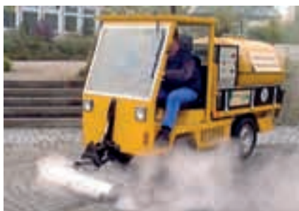
Abb. 2: Links das Hohenheimer Heißwasser-Versuchsgerät beim Einsatz im Obstbau (Photo: Kleisinger), rechts ein Heißwassergerät der Fa. Görgens beim Einsatz auf Pflastersteinen (Photo: Fa. Görgens).
