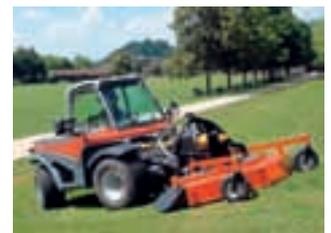
Bis auf die unterschiedlichen Detroit VM Dieselmotoren mit Turbolader, sind die zwei Modelle technisch baugleich. Verrichtet im TT220 ein 3-Zylinder mit 65 PS seinen Dienst, so leistet der 4-Zylinder im TT240 satte 81 PS. Der hydrostatische Fahrtrieb lässt sich in der geräumigen Komfortkabine über den multifunktionalen Fahrhebel stufenlos regeln.
