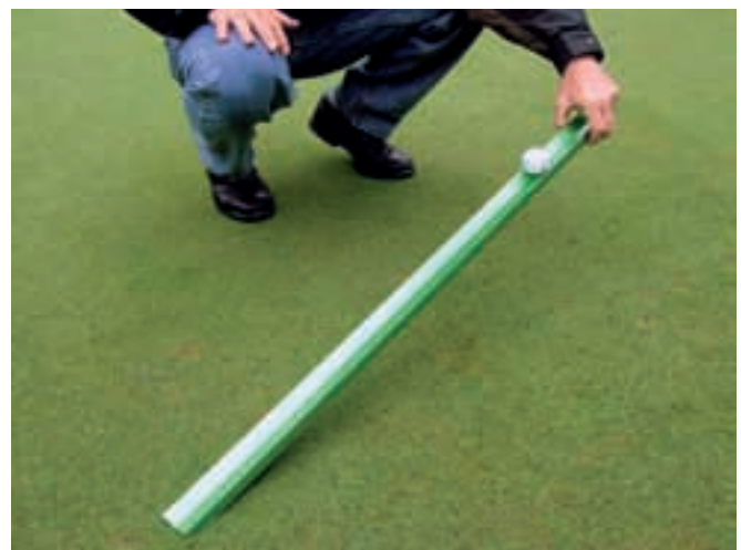
Test des Einflusses eines Rollers auf die BRD
