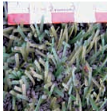
Nahaufnahme eines Sand-Gummi-granulat verfüllten Kunststoffbelages
