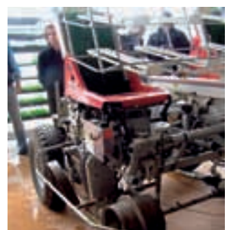
Umgebaute Pflanzmaschine für die Ablage von Einzelgräsern aus Multitopfplatten
