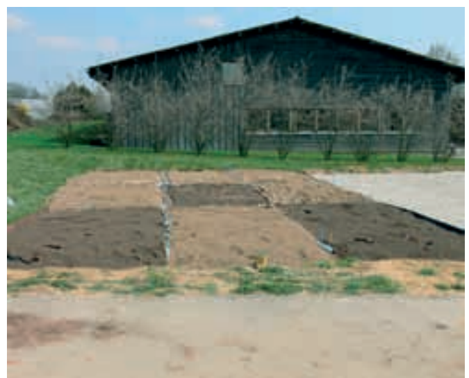
Abb.7: Komplett eingebautes Versuchsfeld vor dem Verdichten Dunkles Material: Vergleichssubstrat, Helles Material: Prüfsubstrat (Foto: Henle)
