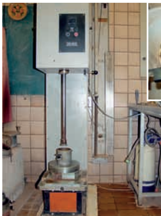
Abb.: 4 Verdichtungsgerät nach Proctor. (Foto: Münster)
