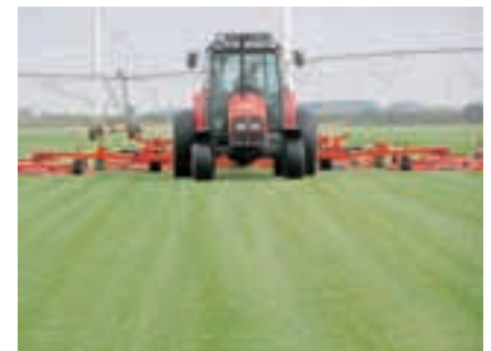
Einsatz des Großflächen-Sichelmähers zur schlagkräftigen Mäharbeit. (Im Hintergrund Blick auf die Beregnungsanlage)
