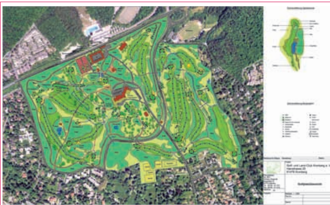
Der Bestandsplan einer 18 Löcher-Golfanlage wurde mittels GPS-Vermessung erstellt, die Waldflächen wurden aus dem Luftbild übernommen und nachgezeichnet.
