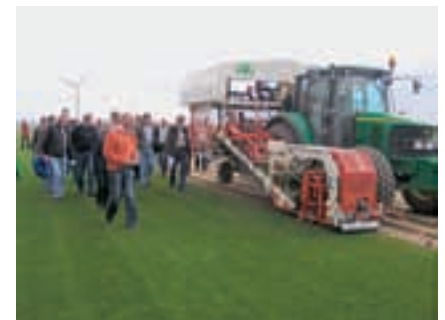
Vollautomatische Ernte der Rasensoden in der Breite von 60 cm mit direkter Ablage auf der Palette.
