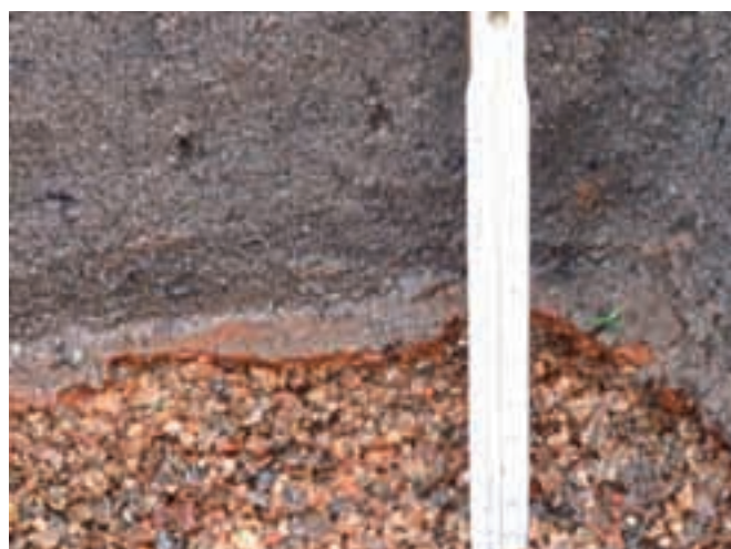
Abb. 3: Lage der Kolmationsschicht zwischen Dränschicht und Rasentragschicht; typische Farbausprägung: im Kern rostbraun, darüber dunkler gefärbt
