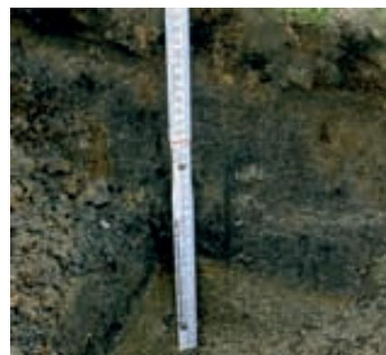
**Abbildung 6: Grünsaufbau mit Black- Layer Bildung im Schadstellenbereich**
