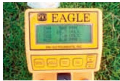
Abbildung 7: Zusammensetzung der Bodenluft in verdichteter Rasentragschicht: Geringer Gehalt an Sauerstoff, zu viel Kohlendioxid und Nachweis von Methan
