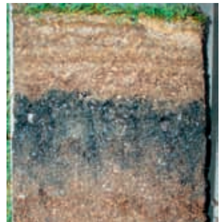
Abbildung 5: Typisches Erscheinungsbild von Black Layer unter abwechselnden Lagen von Filz und Tragschicht (Sandwich)
