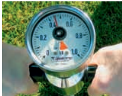
Abbildung 2: Messung des Eindringwiderstandes als Maß für die Bodenverdichtung mit einem Penetrometer
