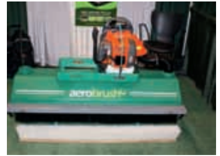
Abb. 3: Das Anbaugerät Aerobusch zum Einarbeiten von Sand in die Aerifizierlöcher
