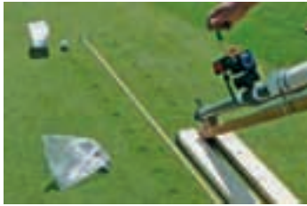
Abb. 2: Pneumatisches Ausstoßgewehr zur Erstellung von „Ball Mark“,
