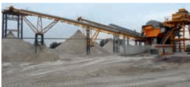
Abb. 3: Schöpfradanlage mit Förderbändern zur Basis-Trennung der Sandfraktion
