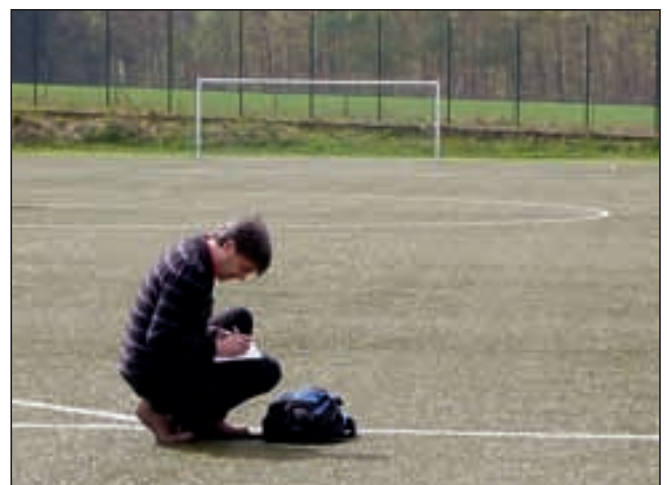
Abb. 7: Kritische Prüfung des Belages des Kunststoffplatzes bezüglich Granulatverfüllung und Florlänge im Trainingsgelände der Sportschule Hennef Fotos: K.G.Müller-Beck
