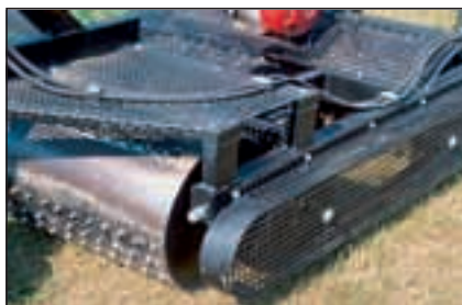
Abbildung 9: Scherstollenwalze des Institutes für Ingenieurbiologie und Landschaftsbau, Ausschnitt
