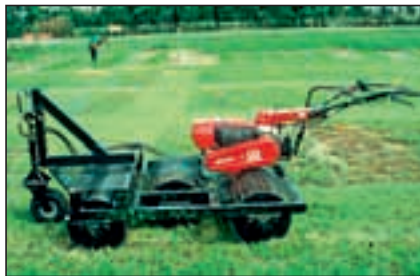
Abbildung 8: Scherstollenwalze des Institutes für Ingenieurbiologie und Landschaftsbau, Gesamtansicht
