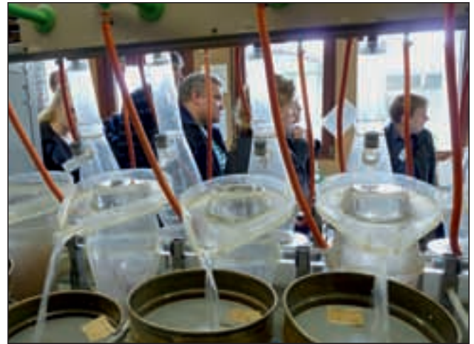
Abb.4: Vor der Auszählung von Boden-Nematoden erfolgt die Ausschwemmung über geeignete Siebe im Labor Fotos: K.G.Müller-Beck
