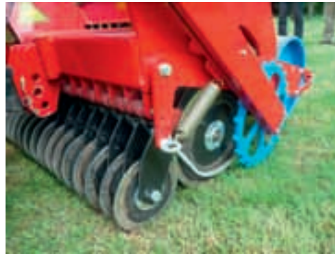
Modifizierte Scheibenseche am Arpo-Tec Gerät sorgen für einen engen Reihenabstand.
