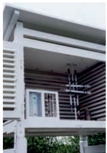
Abb. 1: Die klassische Gießener Hütte liefert Temperatur- und Feuchtedaten aus zwei Meter Höhe.
