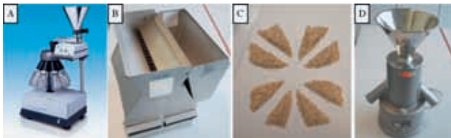
Verschiedene Probeteilungsgeräte und -methoden (A: Rotationsteiler (Bild: Fa. Retsch), B: Riffelteiler mit 18 Kanäle, C: Handhalbierung, D: Zentrifugalteiler).
