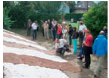
Test von Schafwoll-Saatmatten zur Erosionsschutzbegrünung.
