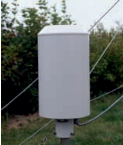
Abb. 3: Ein Ombrometer misst automatisch und hochauflösend den Niederschlag.
