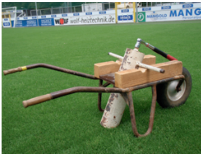
Abb. 2: Stollenschergerät mit aufgesetztem Drehmomentschlüssel. Scholz-Arena Aalen, 15.7.2010.
