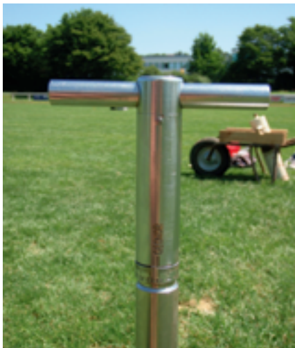
Abbildung 3: Flügelsonde: Drehgriff und Skala. Weiherstadion Hechingen. 5.7.2010.
