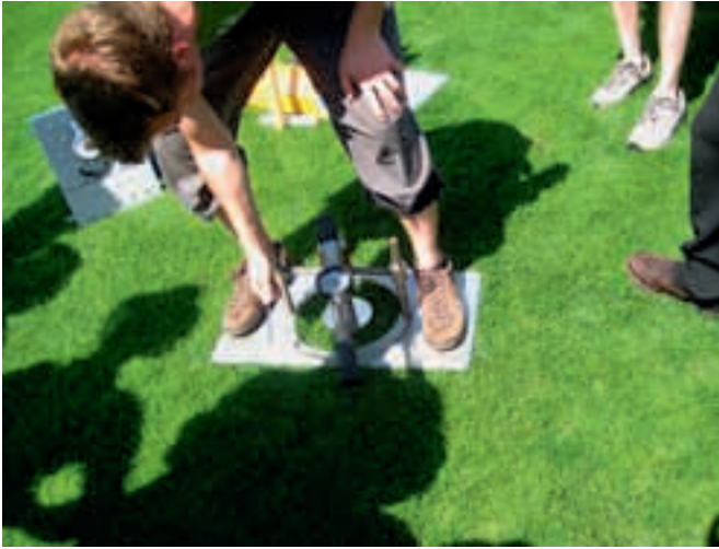
Abb. 4: Scherkrantz zur Messung der Scherfestigkeit einer Rasennarbe (FH Erfurt).
