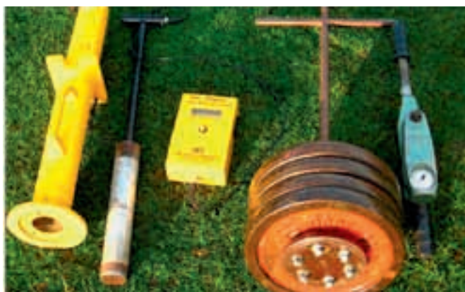
Abb. 5: Messgeräte zur Prüfung der Oberflächenhärte (li.) sowie zur Ermittlung der Scherfestigkeit einer Rasennarbe.
