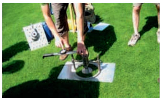
Abb. 6: Scherkranz (vorne re.) zur Messung der Scherkräfte einer Rasennarbe. Oben li. ein Scherschleppwagen zur Ermittlung der Scherfestigkeit einer Rasennarbe. Entwicklung an der FH Erfurt.
