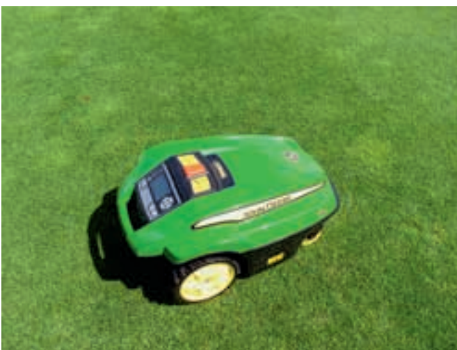
Abb. 6: Prototyp der Neuentwicklung eines programmierbaren Mäh-Roboters von John Deere. Fotos: K.G. Müller-Beck
