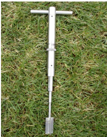
Abb. 5: Die Flügelsonde misst die Scherfestigkeit der Rasentragschicht. Foto: H. Nonn
