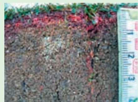
Abb. 7: Eingefärbtes Öl dringt in den Boden ein.
