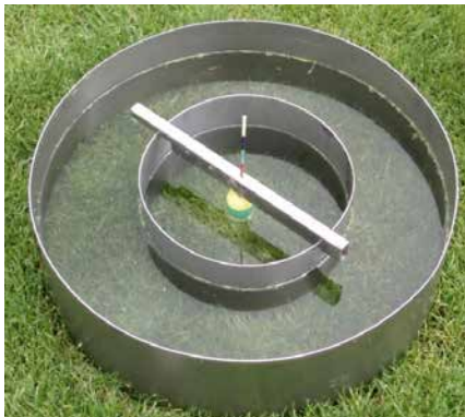
Abb. 4: Überprüfung der Wasserdurchlässigkeit mit dem Doppelring-Infiltrimeter. Foto: H. Nonn
