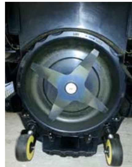
Abb. 3: Sichelmäherprinzip auch bei Mährobotern (Henle, 2013).
