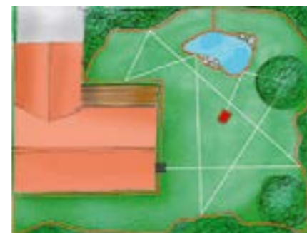
Abb. 4: Mähen innerhalb einer definierten Zielfläche nach dem Zufallsprinzip, durch Stoßsensoren werden Hindernisse erkannt ( http://www.deere.de/wps/wcm/connect/de_DE/products/equipment/autonomous_mower/tango_e5/tango_e5.page ).
