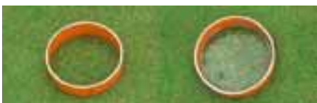
Infiltrationstest auf Golf-Green links KICK® LDS, rechts unbehandelt
