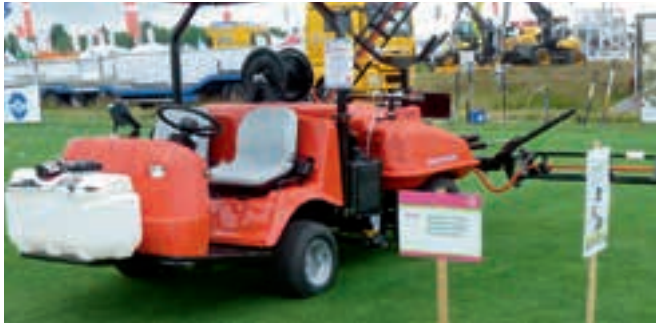
Abb. 10: GIS-gesteuerte Spritze für den Einsatz auf dem Golfplatz.
