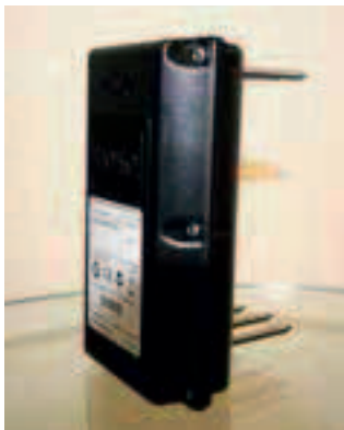
Einer von fünf verbauten Bodensensoren mit Messstiften für Wasser- und Salzgehalt sowie Bodentemperatur.
