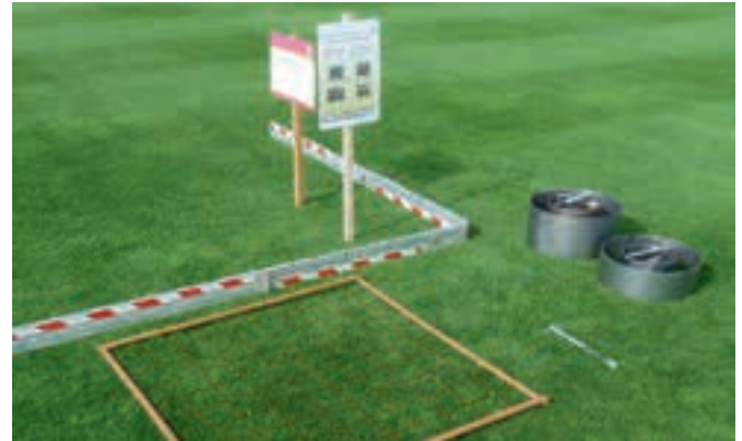
Abb. 13: Hilfsmittel zur Erfassung geeigneter Qualitätskriterien beim Rasen: Boniturrahmen, Flügelsonde, Doppelring-Infiltrrometer, Messlatte.
