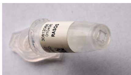
Abb. 4: Das neu entwickelte Mikroarray-Röhrchen enthält einen mikroskopisch kleinen Chip (3 mm 2 ), auf welchem DNA von 90 Rasenkrankheitserregern aufgebracht ist.
