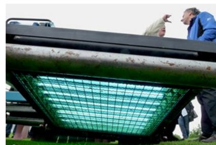
Abb. 3: Belichtungseinheit des UVC-Gerätes.
