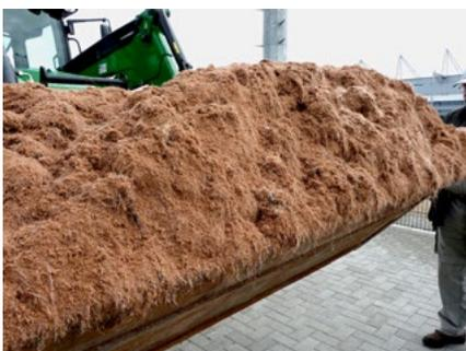
**Abb. 7: Fertig gemischtes, armiertes RTS-Material (Fibrelastic) für den Einbau eines Trainingsplatzes.**
