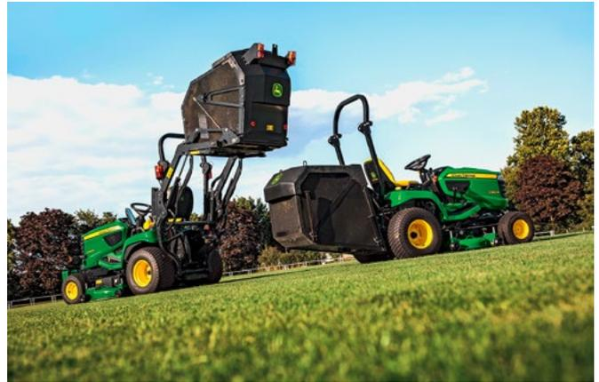
**Highlight des John Deere X950R ist das innovative Schnellwechselsystem, das einen unkomplizierten und schnellen An- und Abbau des Heckgrasfangbehälters ermöglicht.**
