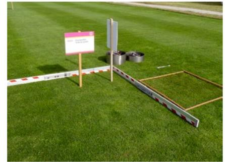
**Abb. 6: Wichtige Hilfsmittel wie Doppelring-Infiltrometer, Flügelsonde, Schätzrahmen oder Richtlatte werden zur Prüfung der Rasenqualität genutzt. (Foto: K.G. Müller-Beck)**
