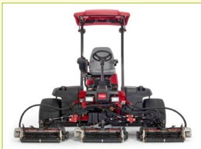
Beim Toro Reelmaster 5010-H handelt es sich um einen Fünffach-Fairway-Mäher. Die größte Innovation des Fahrzeugs ist der Voll-Hybrid-Antrieb. Der Mäher erhält in Leistungsspitzen durch eine Batterie zusätzlich Energie. Die Kraftstoffersparnis liegt bei rund 20 Prozent. Der Motor liefert 18,5 kW/24,8 PS, mit Hilfe der Batterieunterstützung leistet die Maschine dann bis zu 30 kW/40 PS. Auch die Lagerungen und Dichtungen der Schneideinheiten wurden auf die
