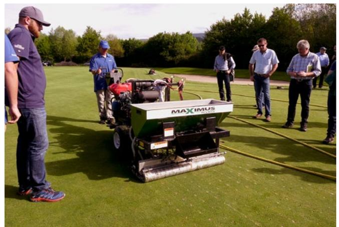
Abb. 8: Sandinjektion auf dem Golfgrün mit dem „DryJect-Gerät“. (Foto: K.G Müller-Beck)
