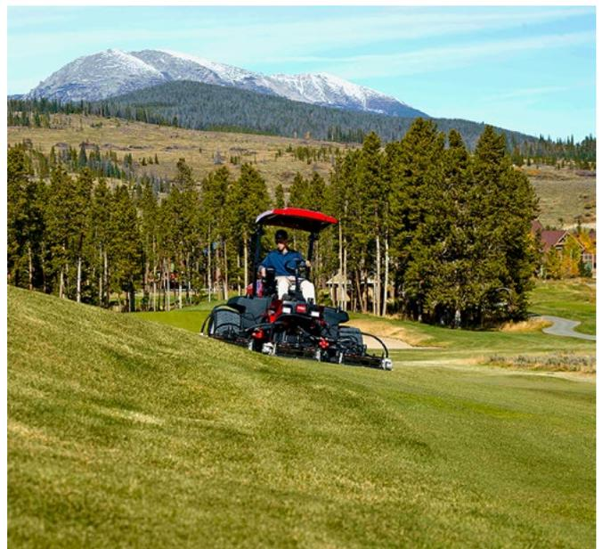
**Bei Bedarf – wie hier in hügeligem Gelände – unterstützt der Batterieblock den Dieselmotor. Wird die Zusatzleistung nicht mehr benötigt, übernimmt der Motor alleine und lädt gleichzeitig den Batterieblock wieder auf.**
