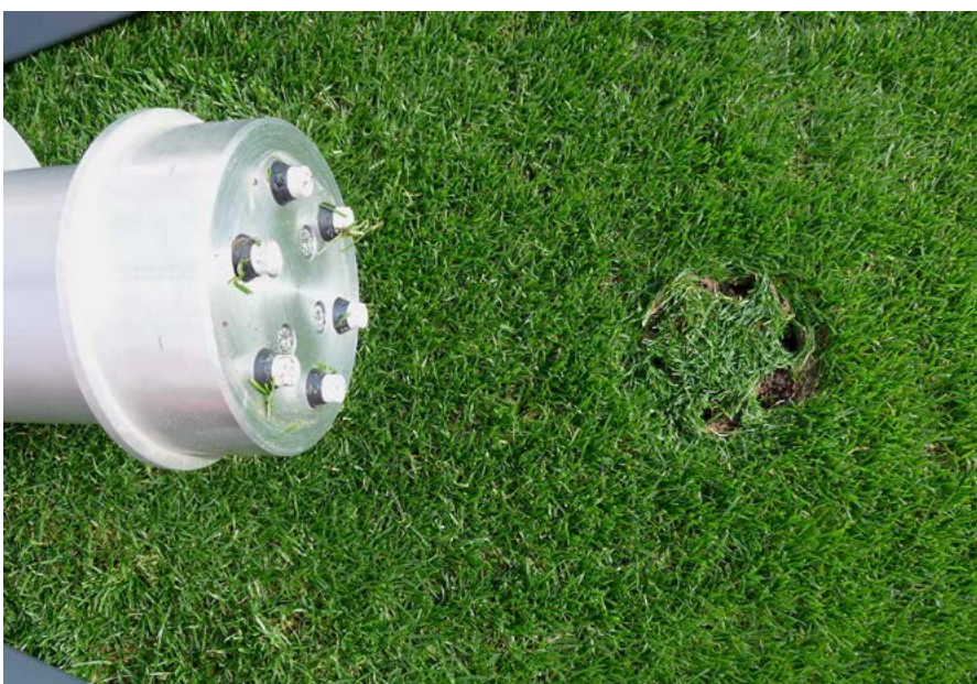
Abb. 6: Eingriff des Stollenschergerätes in der Rasennarbe nach Messvorgang.
