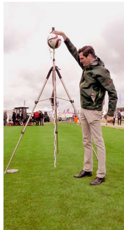
Abb. 2: Vertikaler Ball-Rückprall auf der Rasenfläche aus der definierten Fallhöhe von 2,0 m.
