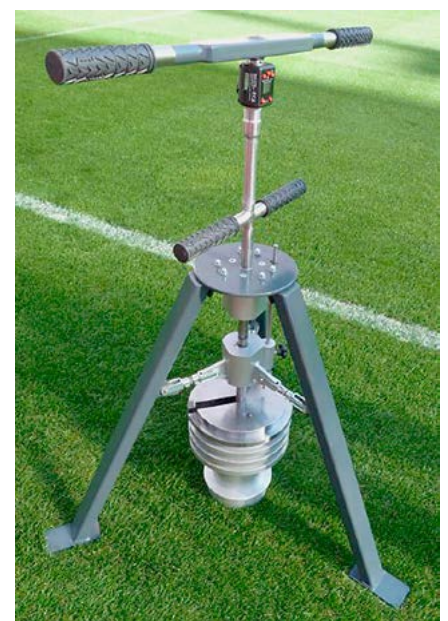
Abb. 7: Stollenschergerät zur Messung der Scherkräfte einer Rasennarbe in Newton Meter (NM).
