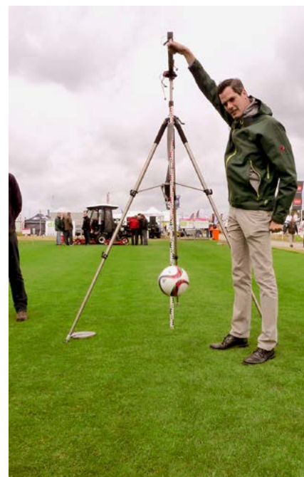
Abb. 3: Geringer Rückprall von ca 40 cm auf der wassergesättigten, weichen Rasenfläche.
