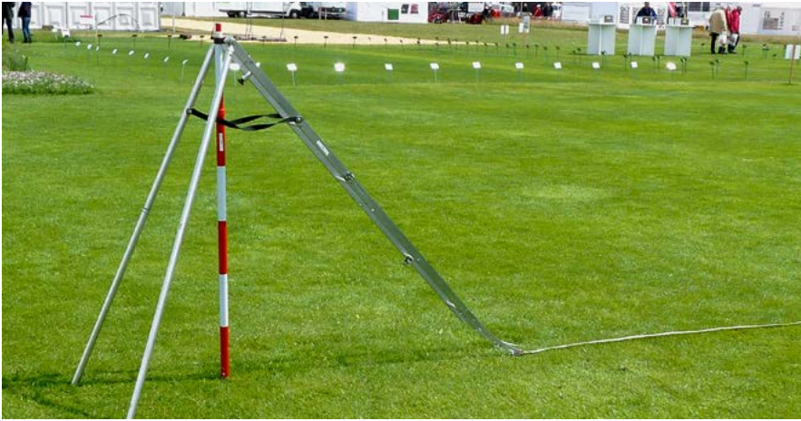
Abb. 4: Stativ mit Ausrollschine zur Ermittlung der Ball-Roll-Strecke auf der Rasenfläche.
