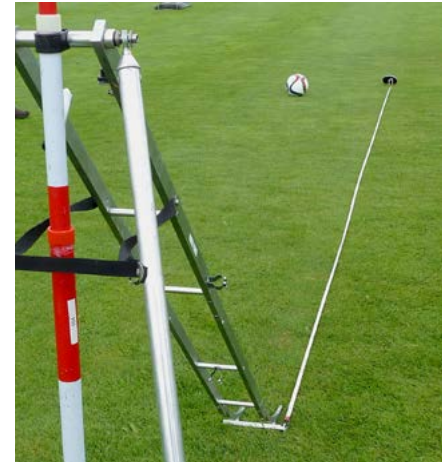
Abb. 5: Ball-Roll-Strecke von 5,75 m bei einer Starthöhe von 100 cm und einem Gefälle von 45°.
