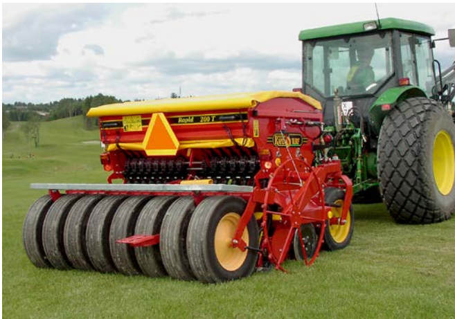
Die universell einsetzbare „Väderstad Turf“ ist eine auf deutschen Golfplätzen verbreitete Maschine. Sie legt den Kalkstickstoff unterhalb der Grasnarbe ab. Neben der anhaltenden Stickstoffwirkung unterdrückt die Anwendung auch die Ausbreitung von Gartenlaubkäfern oder Tipuliden. (Werkfoto)
