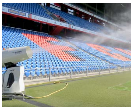
Abb. 4: Staubbindemaschine im Baseler „Joggeli“-Stadion zur Kühlung.
