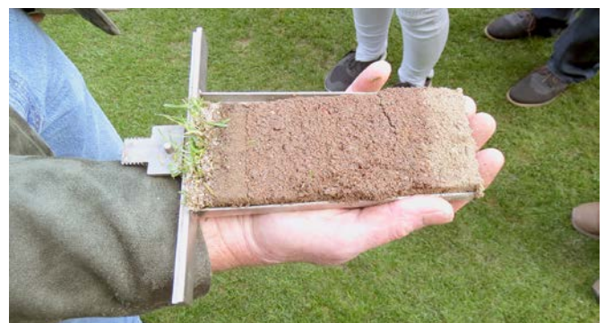
Abb. 3: Die neue Rasentragschicht im Baseler „Joggeli“-Stadion. Eine 10 cm dicke Mischung aus Lava, Rheinsand und Porolith hat das Drainverhalten des Spielfeldes deutlich verbessert.
