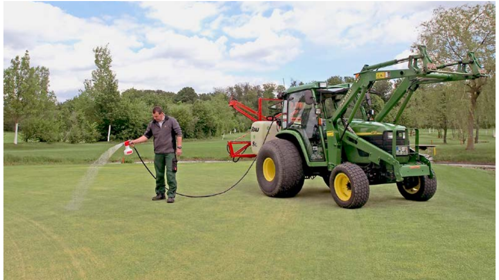
Zum lokalen Ausbringen und Beregnen von Nematoden entwickelt: Der Birchmeier AquaNemix.
