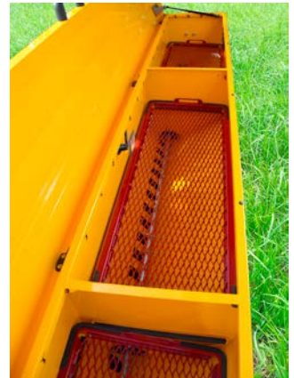
... das optional montierbare Gitter zum Schutz der Rührwelle (rechts).
