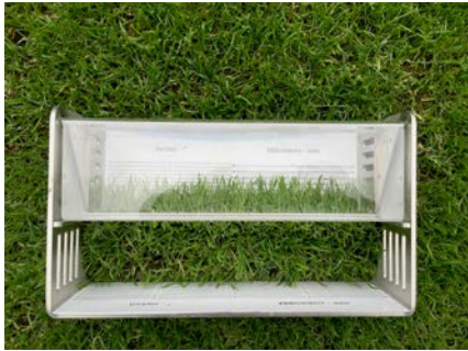
Abb. 7: Rasenprisma zur Bestimmung der Aufwuchshöhe.
