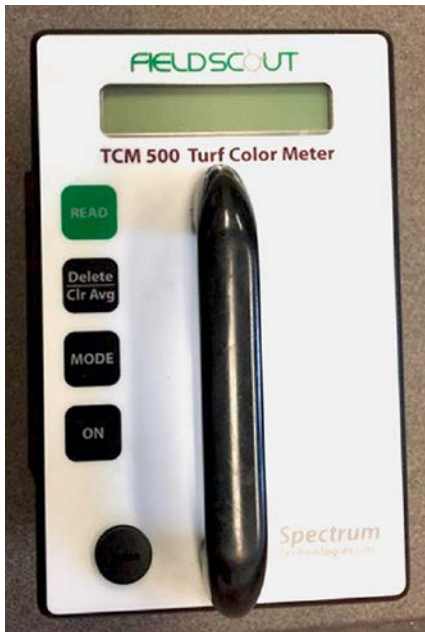
Abb. 9: Field Scout Photometer zum Messen der Farbintensität der Gräser.
