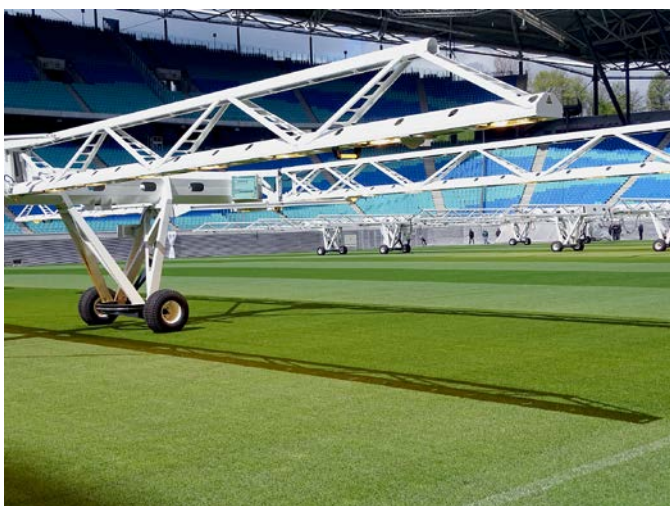
Abb. 5: Stadionrasen mit SGL-Belichtungseinheiten in der Red Bull Arena Leipzig.
