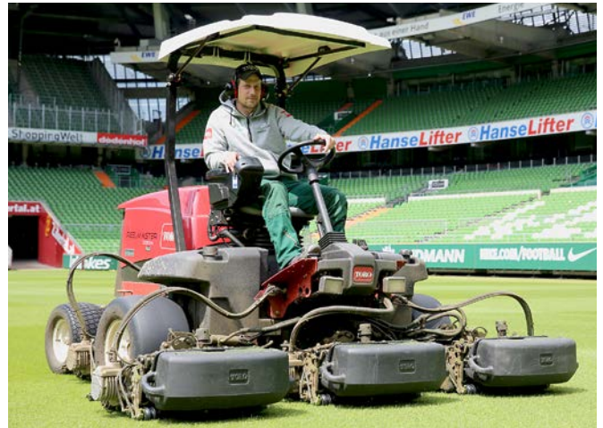
Der Reelmaster 5010-H verfügt über insgesamt fünf Mähwerke.
