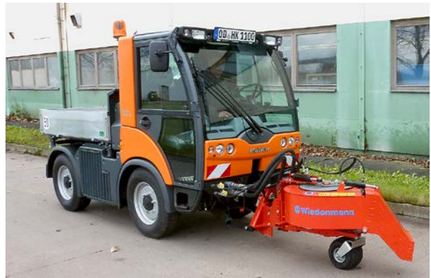
Der Laubbläser Whisper Twister von Wiedenmann mit verbesserter Ausblasdüse und eigenem Hydraulikmotor – geeignet für eine Vielzahl von Trägerfahrzeugen (Foto: Wiedenmann)
