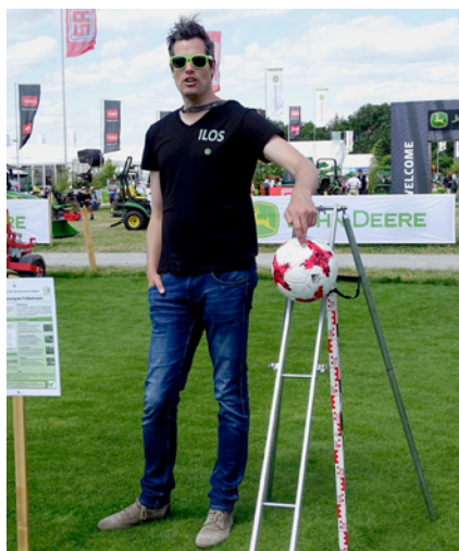
Abb. 6: Stativ mit Ausrollschiene zur Ermittlung der Ballroll-Strecke auf der Rasenflöäche.
