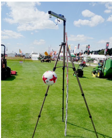
Abb. 4: Vertikaler Ball-Rückprall auf der Rasenflöäche aus der definierten Fallhöhe von 2,0 m.
