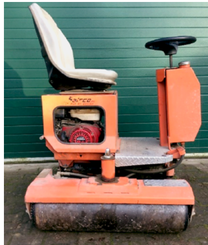
Abb. 1: Salsco-Walze, Arbeitsbreite 0,90 m, Gewicht 155 kg.
