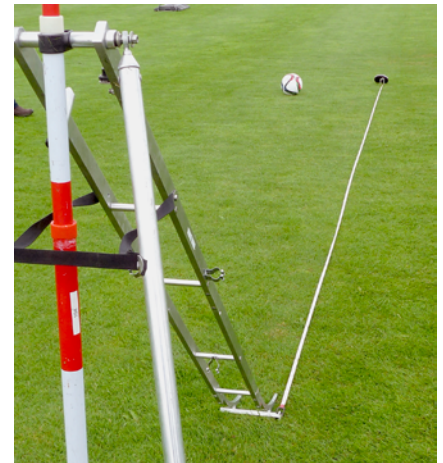
Abb. 7: Ballroll-Strecke von 5,75 m bei einer Starthöhe von 100 cm und einem Gefälle von 45°.
