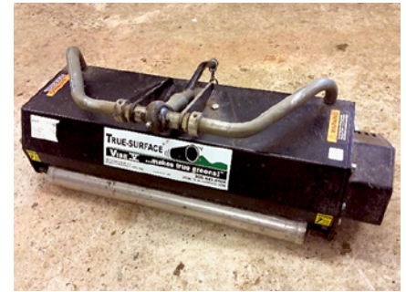
Abb. 2: Vibrationswalze, Arbeitsbreite 1,50 m.
