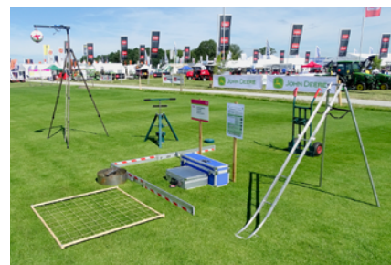
Abb. 3: Messausrüstung zur Ermittlung der Rasenqualität für Sportrasenflächen. Sonderschau Rasen, Eisenach 2017.
