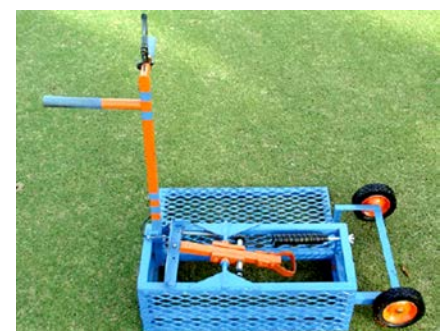
Abb. 9: Sonderanfertigung eines „Divot-Makers“ an der University of Florida zur Erzeugung gleichmäßiger Divots auf Rasenversuchspartellen.
