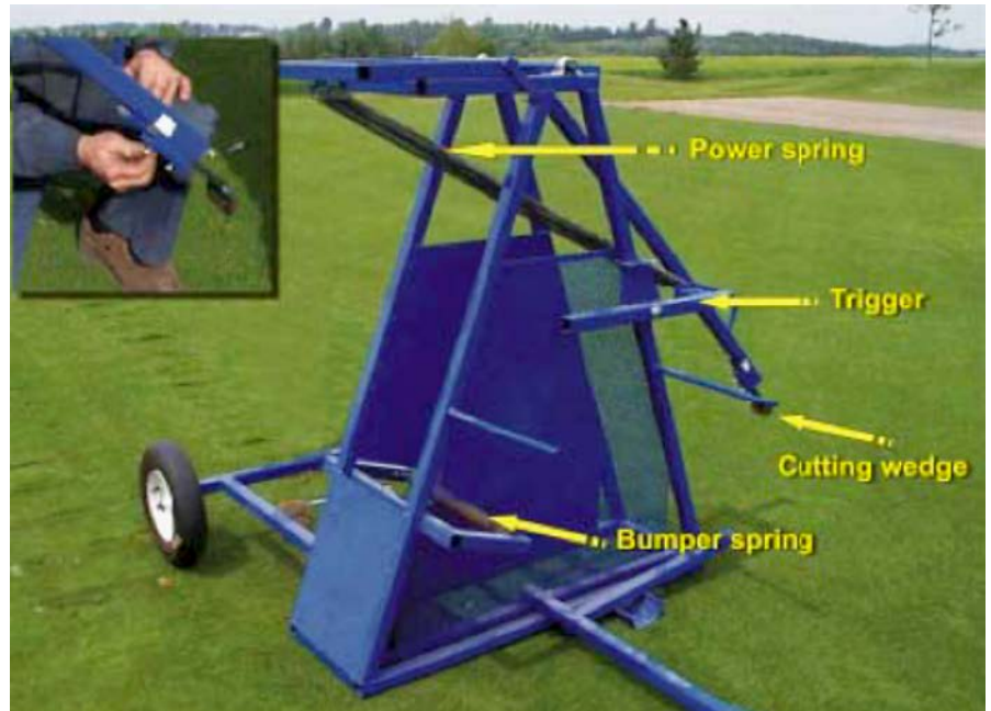
Abb. 8.: Konstruktion eines „Divot Makers“ mit einem justierbaren Wege zur Einstellung der Tiefe beim Ausschlagen von Divots auf Versuchspartellen eines Golfrasens.
