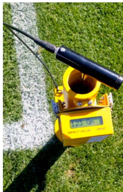
Abb. 6: Digitalanzeige des Clegghammers mit Messergebnis in Gm.
