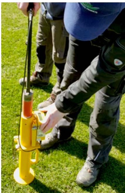
Abb. 5: Clegghammer bereit für die Messauslösung.
