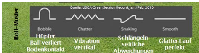
Abb. 4: Exakte Messung der „Green-Smoothness“ mit dem „Trueness-Meter“ oder „Parry-Meter“. (Quelle: WINDOWS and BECHELET, 2010)
