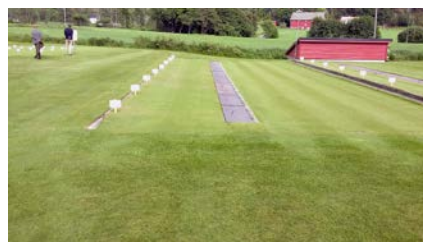
Abb. 2: Versuchsanlage für den „Run Off“-Versuch.
