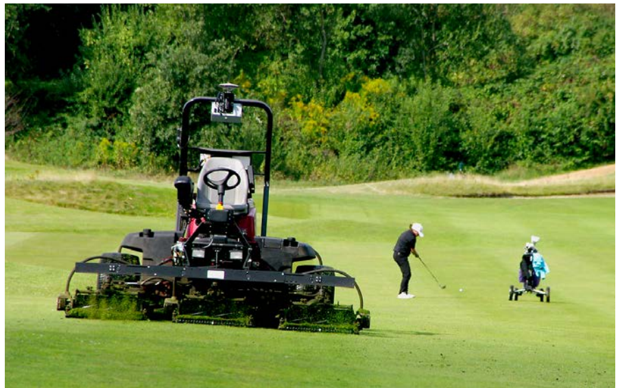
Abb.2: Professioneller Einsatz eines Fairwaymähers mit autonomer, georeferenzierter Steuerung durch GPS-Daten.
