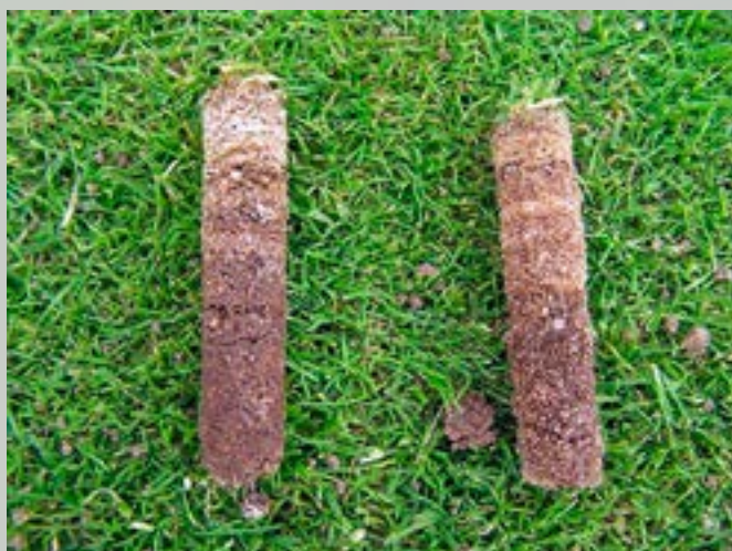
Abb. 3: Bodenkerne aus einer Rasentragschicht nach dem Aerifizieren mit „Thatch“- und „Mat-Horizont“. (Foto: K.G. Müller-Beck)
