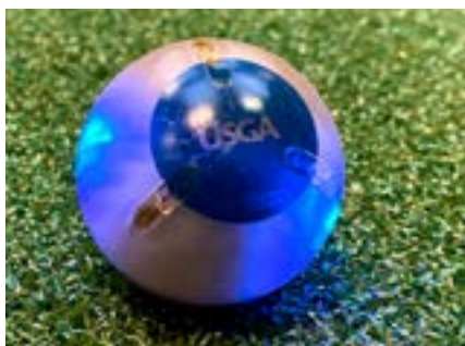
Abb. 5: Der GS3 ist ein neues digitales Testgerät für Grüns und ist vollständig in die Kursverwaltungsplattform der USGA integriert.
